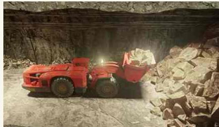
La explotación se inicia quebrando secuencialmente el mineral de cada bloque vertical, desde este punto se extrae el mineral mediante cargadores frontales que lo trasladan hasta una correa transportadora en el nivel inferior de la mina, desde ahí el mineral es llevado a través de un túnel hasta una planta de procesamiento existente hoy en Los Bronces.
