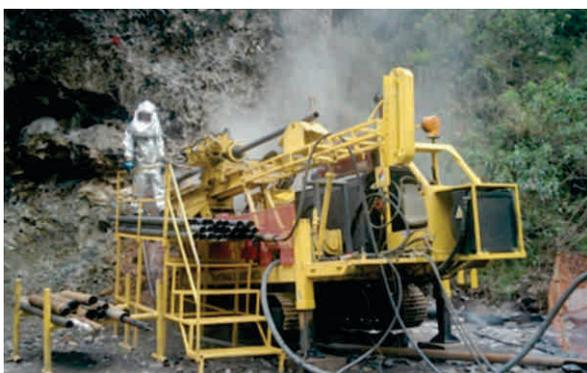
Sondeos donde se aprecia la salida de vapor de agua
